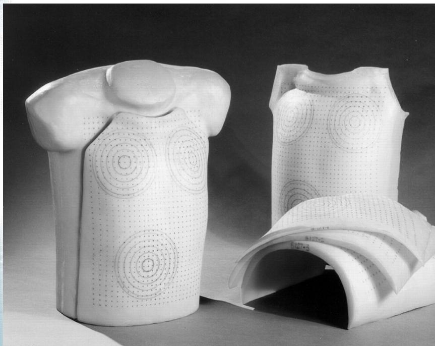
LLNL mellkas fantom a különböző testméreteket imitáló fedőrétegekkel a Nemzetközi Atomenergia Ügynökségtől
