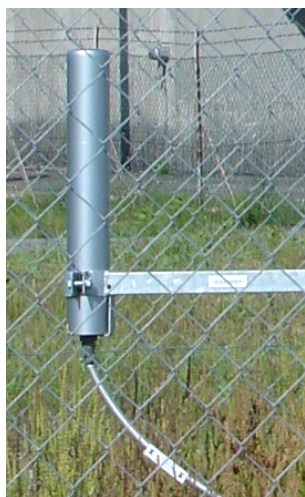
5. ábra. A gamma-sugárzás detektor (Bitt szonda) és érzékenységének irányfüggése
