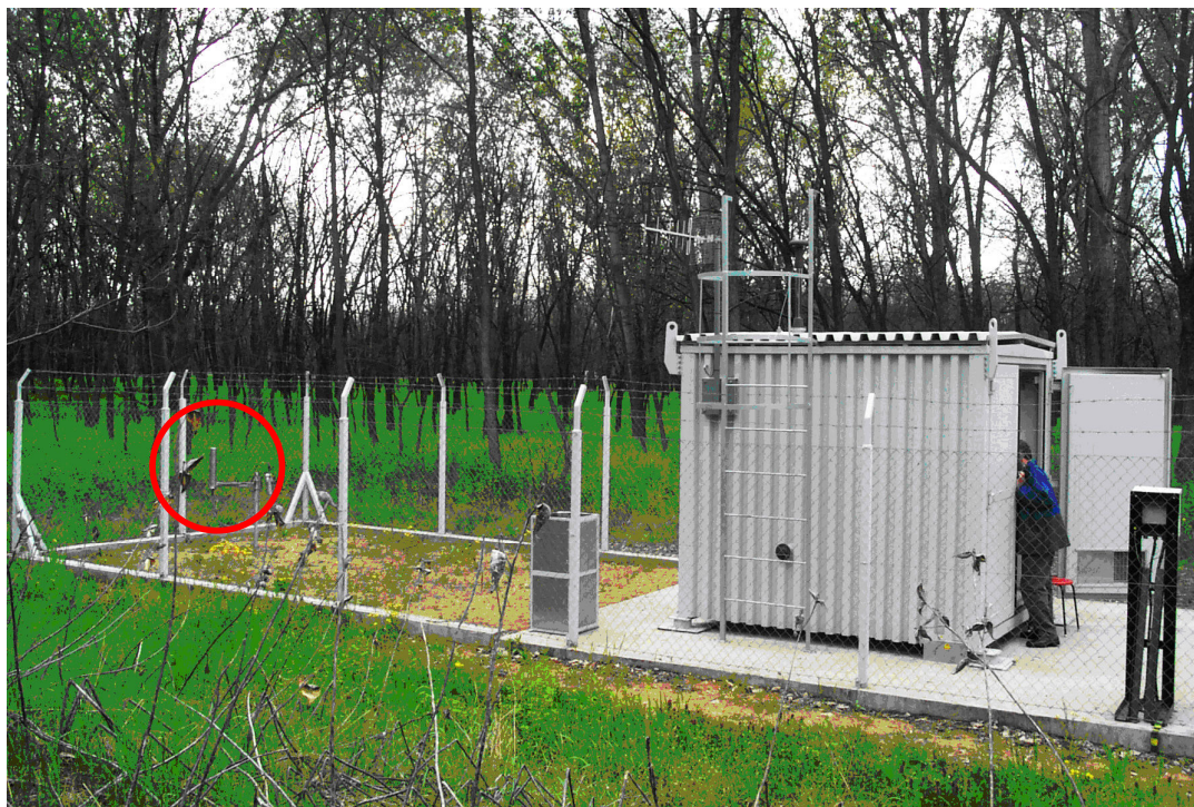
3. ábra. Az A típusú állomás fényképe. A gamma-sugárzást mérő detektort piros körrel jelöltük.
