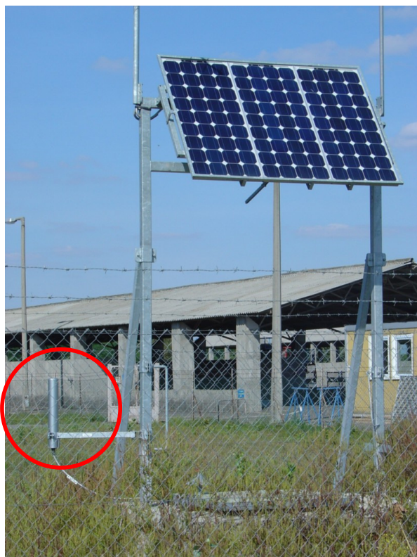
4. ábra. A G típusú állomás. A gamma-sugárzást mérő detektor a piros körben látható. Az állomás tápfeszültségét napelem adja.
