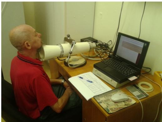
4. ábra: ^{125}\text{I} -el inkorporált személy pajzsmirigymérése, 4/a. ábra: KVSZ pajzsmirigymérővel (2. pozíció), 4/b. ábra: egésztestszámlálóval
