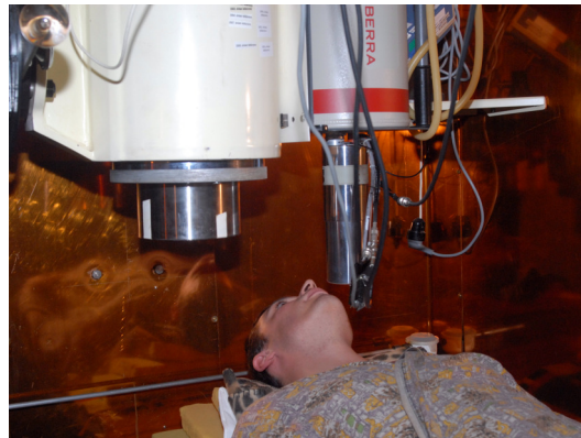
4. ábra: ^{125}\text{I} -el inkorporált személy pajzsmirigymérése, 4/a. ábra: KVSZ pajzsmirigymérővel (2. pozíció), 4/b. ábra: egésztestszámlálóval
